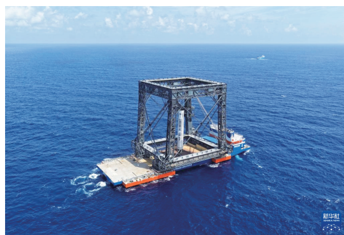
海上回收平台通过网系捕获方式成功回收长征十号乙运载火箭一子级。
