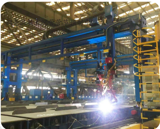
钢壳管节智能制造生产线
