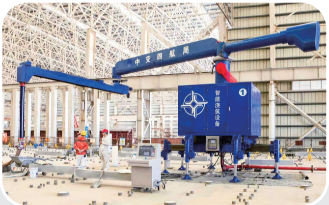
自密实混凝土智能浇筑机器人作业
