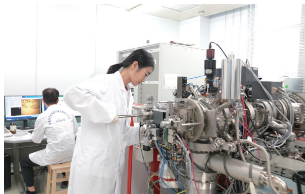
科研人员向离子探针中装检测样品 中国科学院地质与地球物理研究所供图
